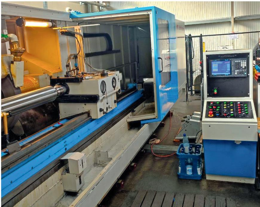
1 Die Außenrundsleifmaschine der Schleiftechnik Witt mit der 'M80'-CNC-Steuerung von Mitsubishi Electric © Mitsubishi Electric
